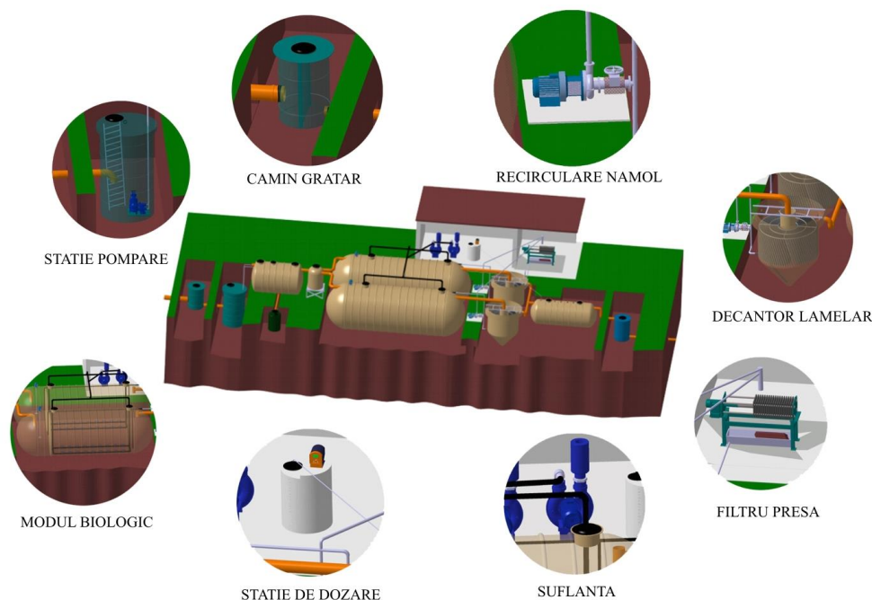
Fig. 2.7. Stație de epurare municipală – model
